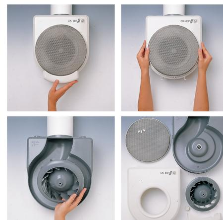
Вентилятор легко разбирается на части, которые можно мыть в посудомоечной машине (при максимальной температуре +60°C).
